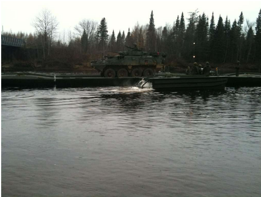
Le VBL III de E11A (Le Cmdt de la Tp 1) est en train de traverser la rivière Jacques-Cartier sur un pont flottant construit par la Tp 1
